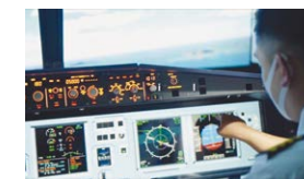
飞行模拟器 1:1 模拟驾驶舱内设有主仪表版、飞行控制组件 (FCU)，以及多用途控制及显示组件 (MCDU)
