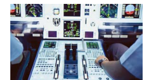
飞行模拟器 1:1 模拟驾驶舱内设有主仪表版、飞行控制组件 (FCU)，以及多用途控制及显示组件 (MCDU)
